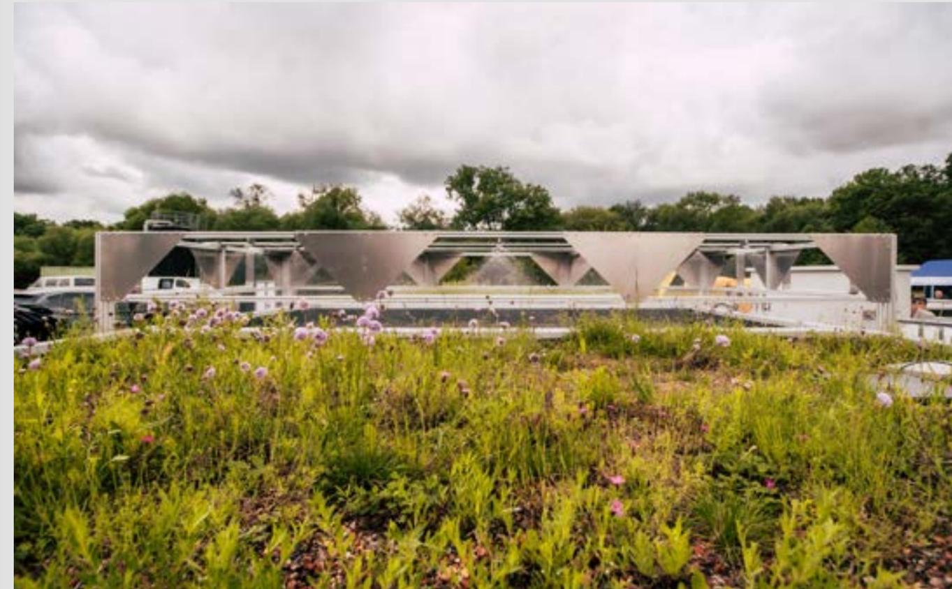
Dränageelemente und unterschiedliche Vegetationstypen berücksichtigt. Spezifische Eigenschaften der verwendeten Substrate wie Speicherkapazität, Porenvolumen etc. werden so einer genaueren Betrachtung unterzogen. Ergänzend wurden ein Kiesdach und ein konventionelles Kunststoffdach aufgebaut. Der Einsatz einer speziellen Sensorik ermöglicht den direkten und exakten Vergleich des Retentionsverhaltens der Dachaufbauten.
